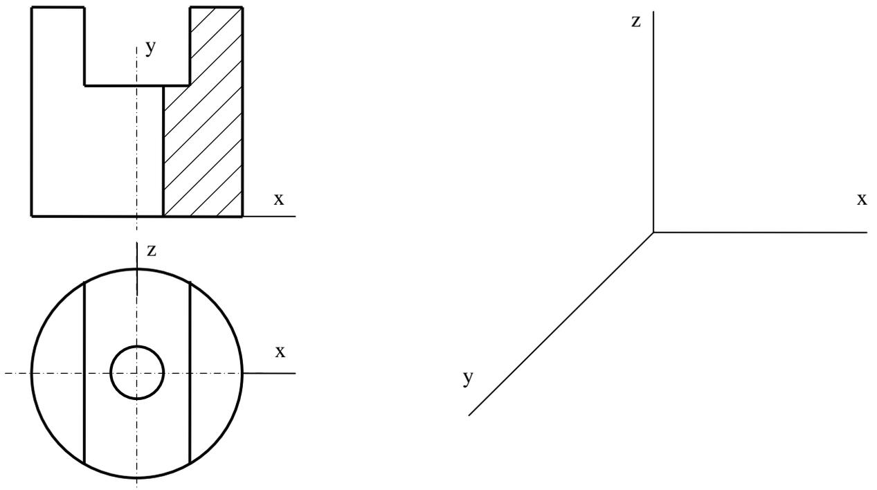
**B4.-** Completar las proyecciones de la pieza de forma que represente el corte que se produciría por el plano longitudinal de simetría. La pieza está determinada por su alzado y su planta.
